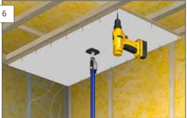
**NO** Forestia Premium Ceiling skrues i noten med Forestia treskrue. Skruvstand cc 150mm. Kramper kan også benyttes. De skal ha rett rygg, min. 10mm bredde og lengden på bena bør være min. 35mm. NB! Trykk på krampestol må justeres nøye. Kramper/skrur skal ikke dykkes, men flukte med overflate i nota.
