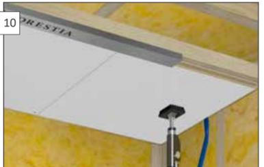
**NO** For å få på plass siste plate, benytt ett brekkjern for å lukke profilen. Benytt styreskinne for siste justering.
