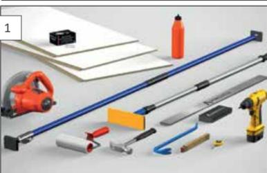
**NO** Ha alt du trenger av utstyr klart før monteringen starter. For takflater lengre enn 8m må det legges inn ekstra ekspansjonsklaring, min. 1,5mm pr. 1m tak. Premium Ceiling monteres på min. 30mm lekter, eller direkte eksisterende plate-himling. **NB!** Forestia Styreskinne og slagkloss er spesialtilpasset profilen til Premium Ceiling. **Benytt Jotun Perfection takmaling eller Beckers Mood Perfect Ceiling med glansgrad 02.**
