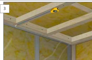
**NO** Monter første platerad etter snor. Husk at det skal være 10mm klaring mot alle faste konstruksjoner. Meget viktig at underlaget er helt rett. Eventuelle ujevnheter i bindingsverket MÅ rettes opp før montering.
