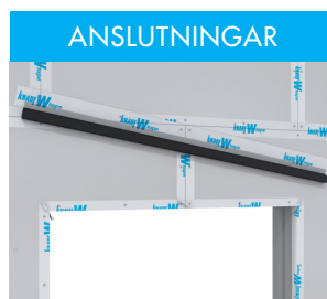
Minst 15 mm under- och överlapp (max 25 cm).
