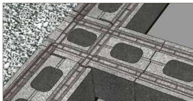
Bild 3.2 Armering av stödvägg
