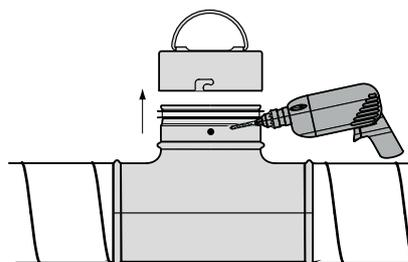
Fest naglene slik at de stikker ut gjennom hullene du har boret. En anbefalt trykktett blindnagle har f.eks. Ø 4,0 og en lengde på 9,5 mm.
