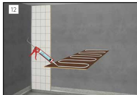
Upprepa appliceringen av lim som beskrivits tidigare.
