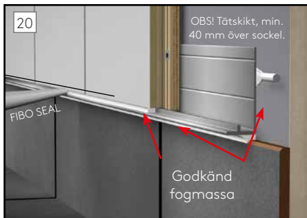
För att monteringen ska vara godkänd och garanti ska gälla måste alltid godkänd fogmassa, Fibo Seal, användas. Se bild för hur fogmassa ska påföras.
